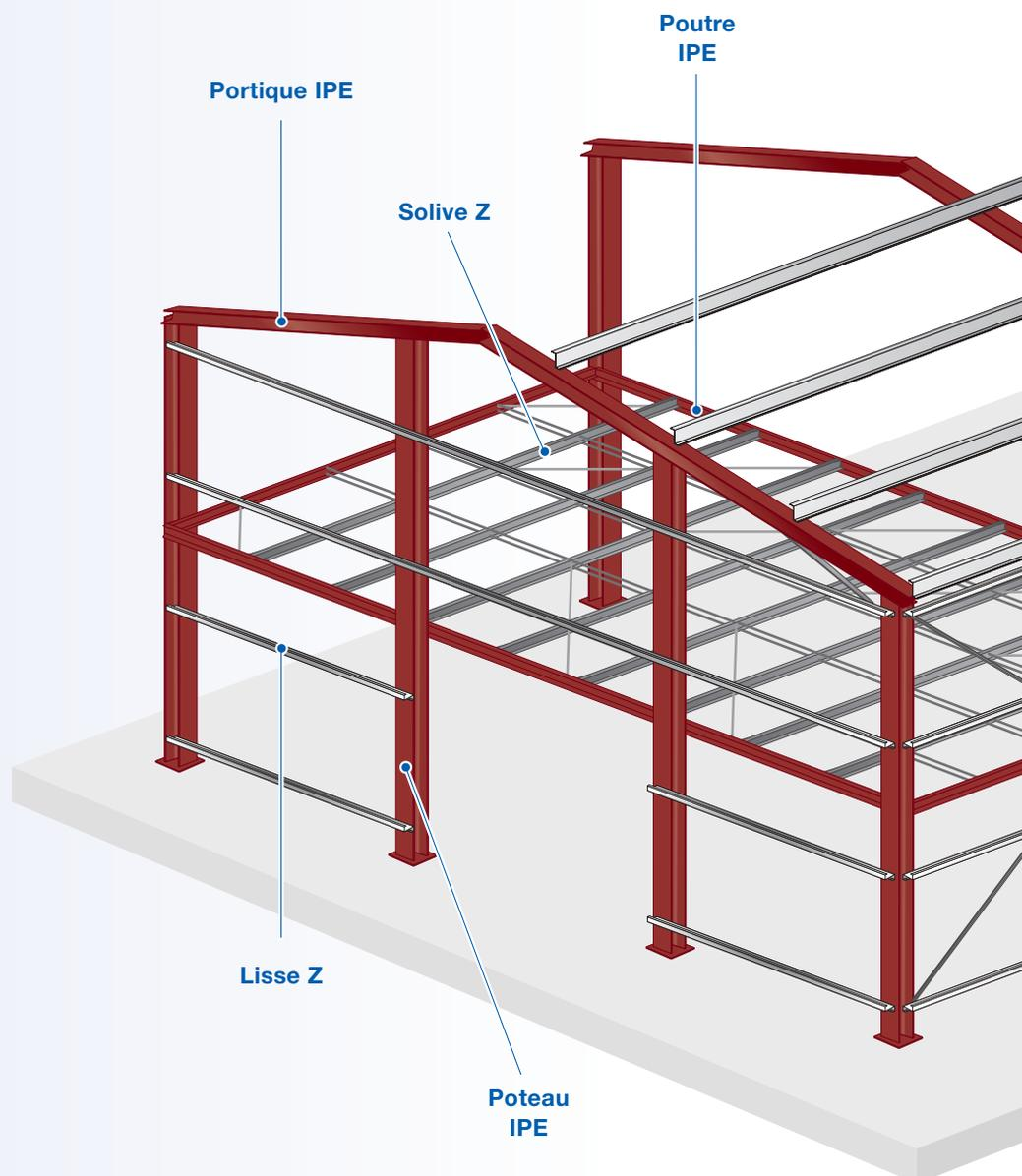
**Panne métallique :** Pièce horizontale d'une charpente de comble autrefois nommée filière. La panne repose sur les arbalétriers des fermes et sert de support aux techniques de couverture.
